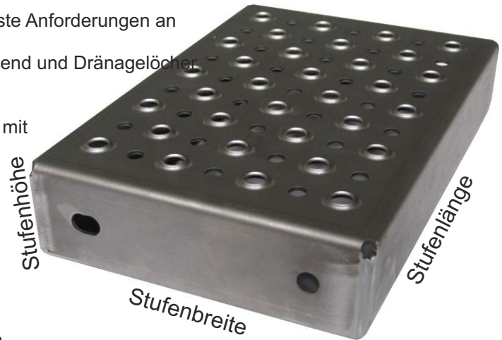
Foto zeigt Treppenstufe aus Schwarzblech (DC01), mit sauber verschweißten und verschliffenen Ecken - bereit zur Feuerverzinkung.
